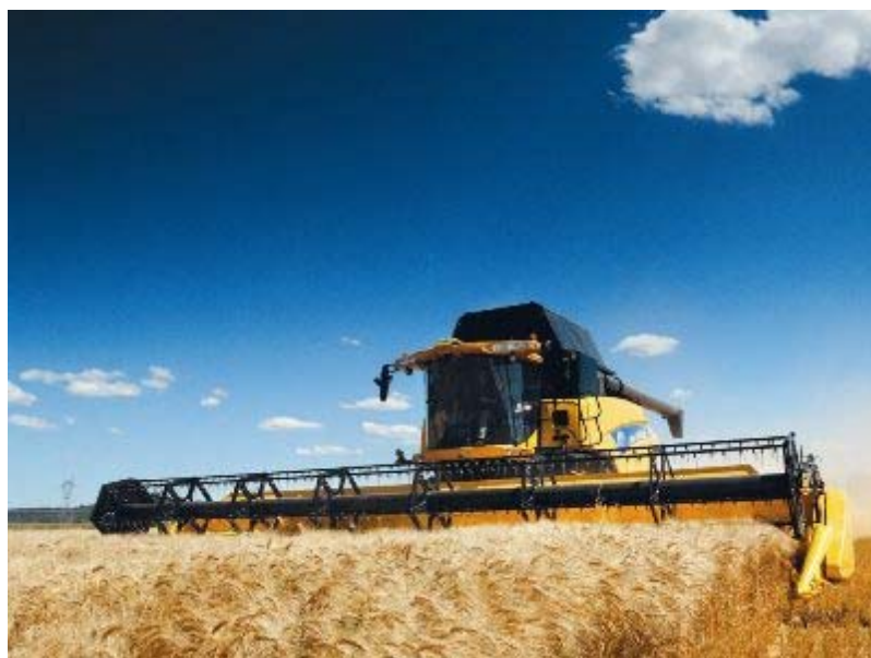
Zwaar belaste mobiele machines worden vaak hydrostatisch aangedreven.
